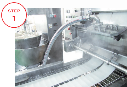
STEP 1 原料の魚肉のすり身をよく練り、シート状にして、蒸す。
