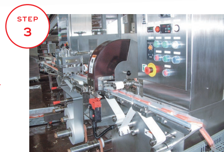
STEP 3 カニカマの赤色は、フィルムに着色して、本体に転写している。途端にカニカマらしさがアップ！
