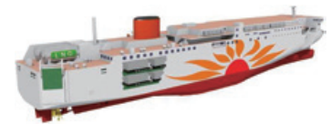
LNG燃料フェリー（本船イメージ）
