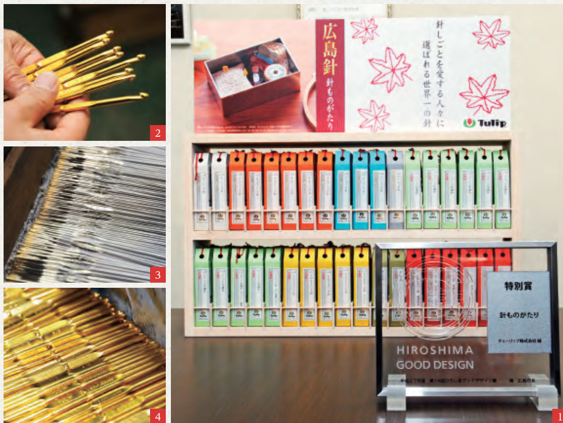
1.「大きめの針穴、曲がりにくくよくなる、最高の布通り。」を実現した手縫針シリーズ「針ものがたり」2.3.4.かぎ針、レース針は徹底したかぎ先研磨で、編み目が揃うならかなかぎ先が特徴。
