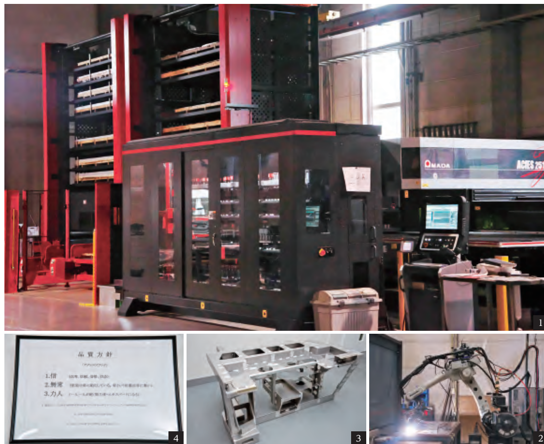
1.アクシスが導入したファイバーレーザー複合機。2.加工面を波型にすることで強度が増す自動溶接機 3.鉄道車輛の運転席部分 4.アクシスの3信条
