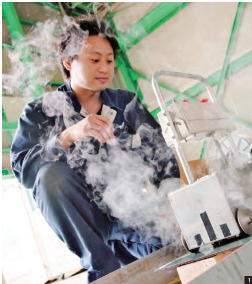
1.主力商品である溶接歪取用高周波誘導加熱装置。2.社是である「共創・共生」。創業からの精神が受け継がれている。3.5.当社の設備・商品の一例。デモ機も多く用意しており、取引先はテストを行ったうえで購入を検討することができる。
